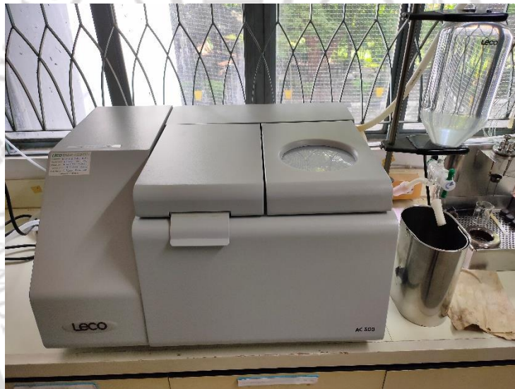
ภาพที่ 3.4 เครื่องวิเคราะห์ค่าความร้อน Bomb calorimeter
