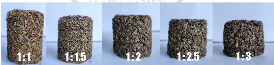
ภาพที่ 4.4 ตัวอย่างเชื้อเพลิงอัดแท่งที่ผ่านการขึ้นรูป โดยใช้กากน้ำตาลเป็นตัวประสาน ที่อัตราส่วนต่าง ๆ
