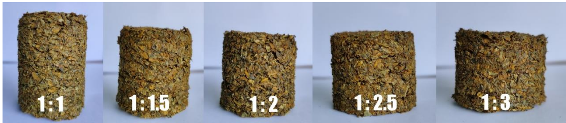
ภาพที่ 4.3 ตัวอย่างเชื้อเพลิงอัดแท่งที่ผ่านการขึ้นรูป โดยใช้ไขมันสัตว์เป็นตัวประสาน ที่อัตราส่วนต่าง ๆ
