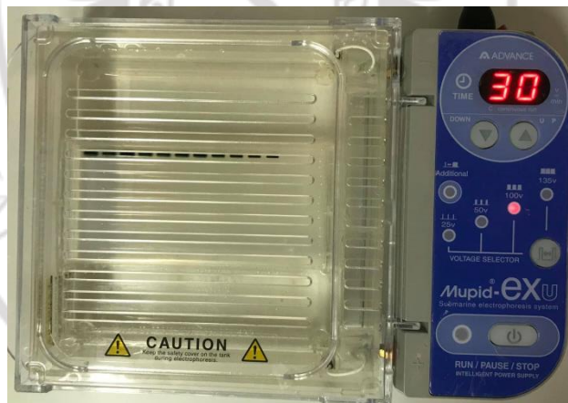
ภาพที่ ง.2 การตรวจ PCR product ด้วย gel electrophoresis
