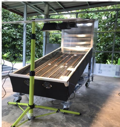
ภาพที่ 3.8 เครื่องอบความร้อนพลังงานแสงอาทิตย์ที่ติดตั้งท่อเทอร์โมไซฟอนที่ทำการทดสอบ
