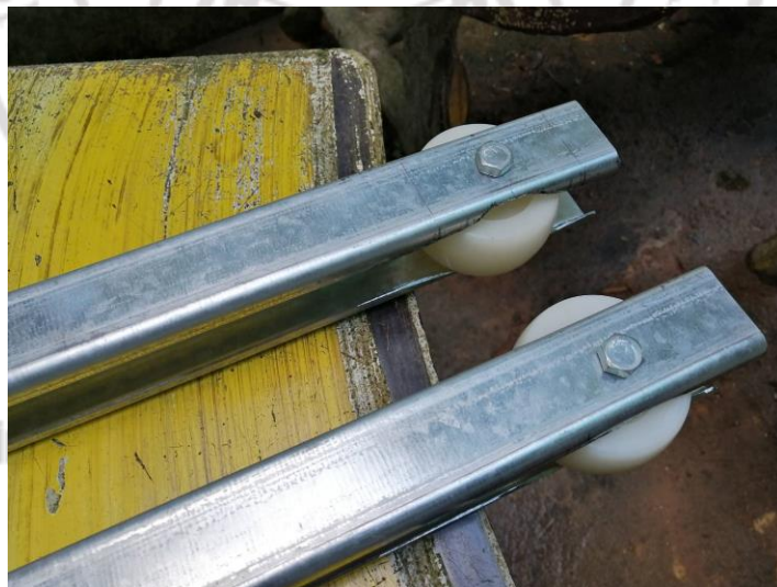
ภาพที่ 4.4 แสดงลักษณะการติดตั้งชุดล้อหน้าของรถเข็นขนส่งผลไม้
