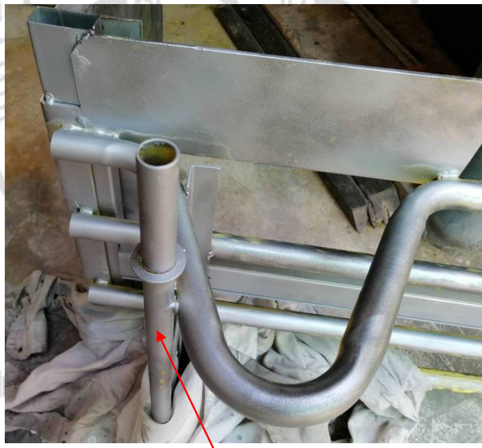
ท่อเหล็กกลมจัดสร้างเป็นเพลาล้อ
