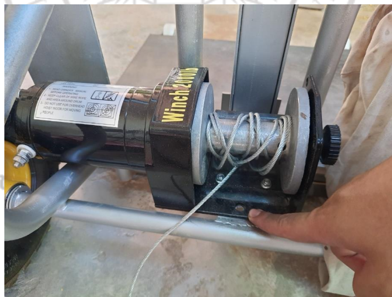
จัดสร้างอุปกรณ์จับยึดรอกไฟฟ้า
