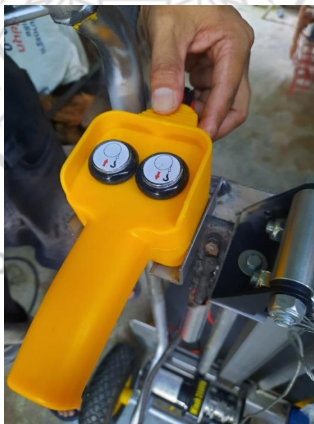
ภาพที่ 4.10 แสดงการติดตั้งชุดรองรับอุปกรณ์คอนโทรลและการติดตั้ง
