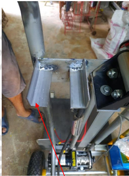
ชุดรองรับอุปกรณ์คอนโทรล
