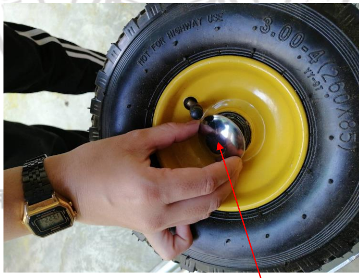
ติดตั้งล้อลมยางเข้ากับแกนเพลาล้อ
