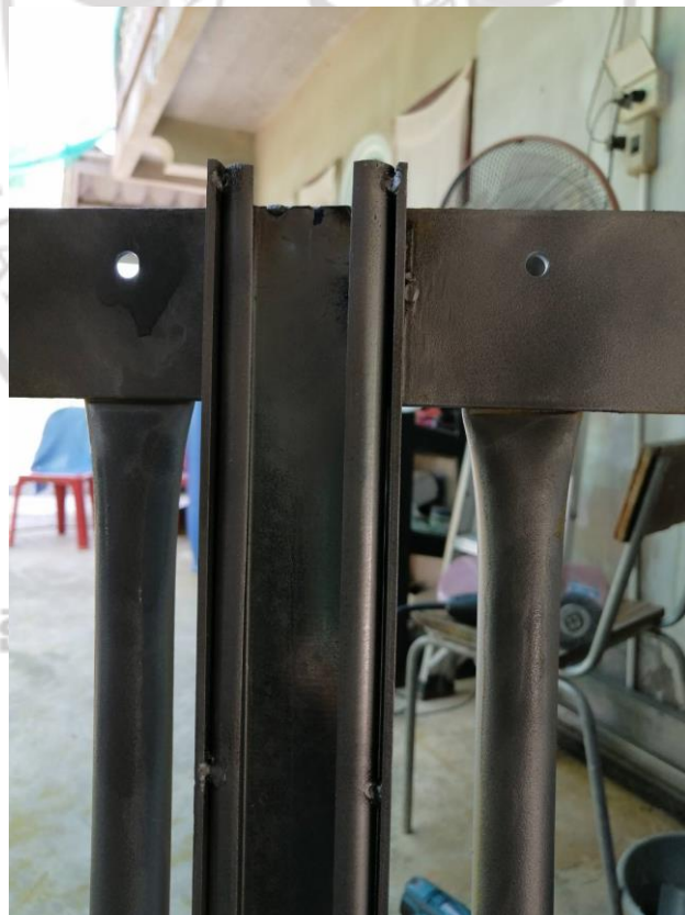
ภาพที่ ข1 แสดงการติดตั้งชุดรางบังคับสลิง
