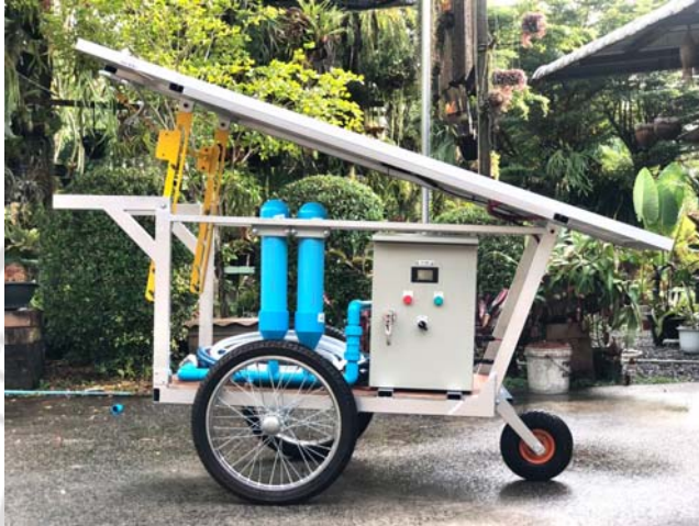
ภาพที่ 4.6 ระบบสูบน้ำเคลื่อนที่พลังงานแสงอาทิตย์สำหรับชุมชนฐานรากในระดับครัวเรือน
