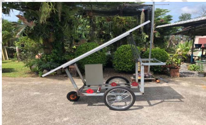
ภาพที่ 4.5 การติดตั้งแผงโซลาร์เซลล์บนโครงสร้างของระบบสูบน้ำเคลื่อนที่พลังงานแสงอาทิตย์
