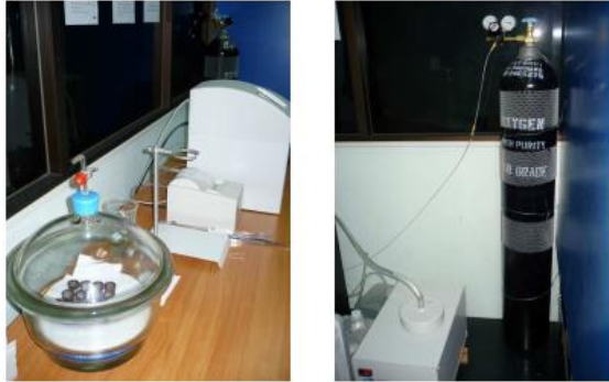
ภาพที่ 2.1 การหาค่าความร้อนด้วยเครื่องบอมบ์แคลอริมิเตอร์รุ่น Pae 6300
