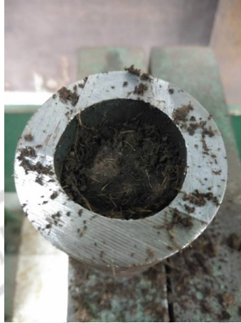
2.4 นำแกนสร้างรูวางไว้บริเวณกึ่งกลางของกระบอกอัด และทำการอัดให้ทะลุถึงฝั่งตรงข้าม
