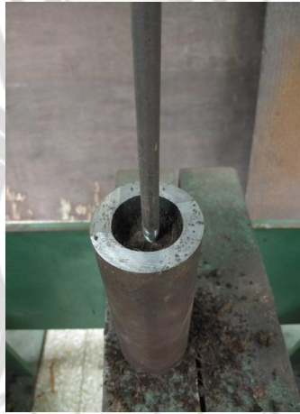
2.4 นำแกนสร้างรูวางไว้บริเวณกึ่งกลางของกระบอกอัด และทำการอัดให้ทะลุถึงฝั่งตรงข้าม
