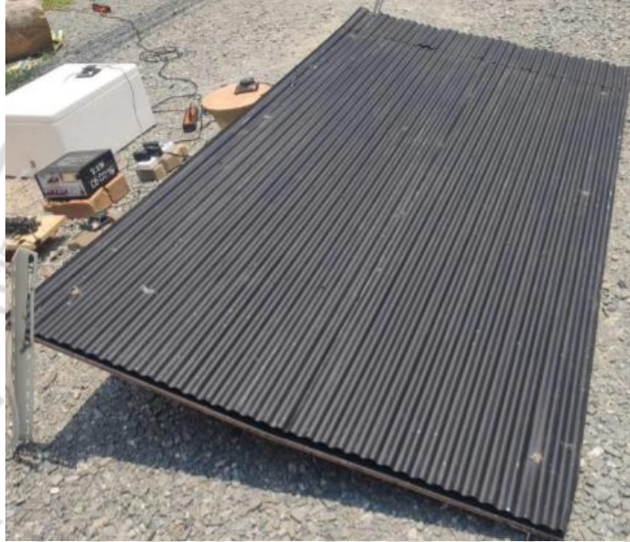
ภาพที่ 3.2 แผงรับความร้อนแสงอาทิตย์แบบแผ่นเรียบ
