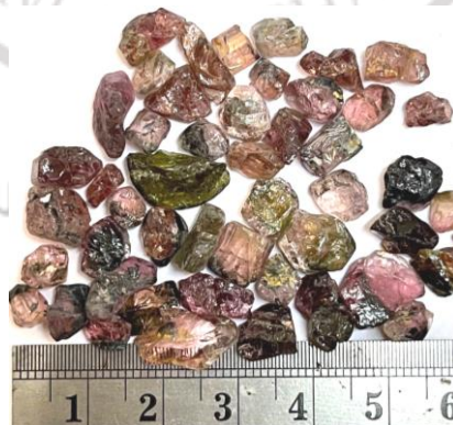
ภาพที่ 4.9 เศษพลอยทัวร์มาลีนลักษณะขอบมนสีโทน Bi-color มีสีชมพูและสีเขียวในก้อนเดียวกัน
