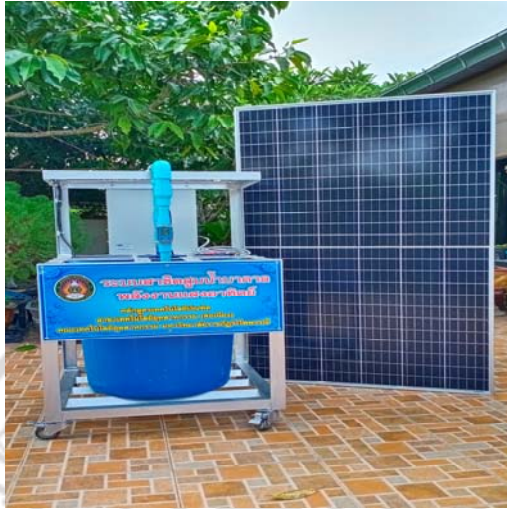
ภาพที่ 4.6 ระบบสาธิตสูบน้ำบาดาลน้ำตื้นพลังงานแสงอาทิตย์ขนาดเล็กสำหรับใช้ในครัวเรือน
