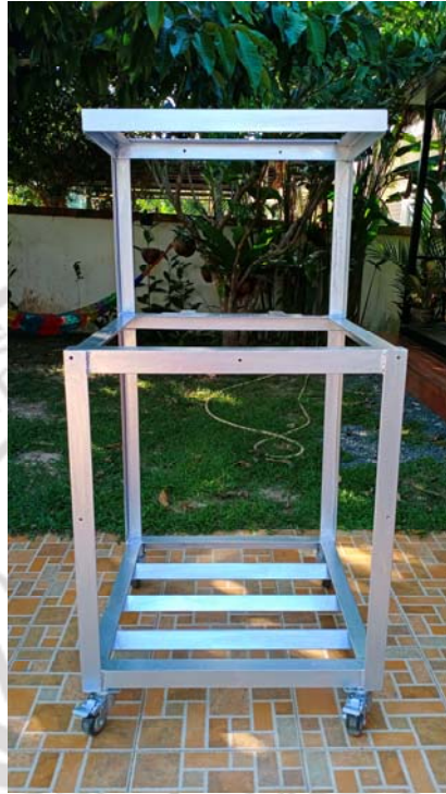
ภาพที่ 4.3 โครงสร้างระบบสาริตสูบน้ำบาดาลน้ำดื่มพลังงานแสงอาทิตย์
