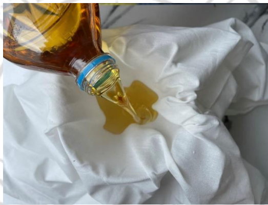
ภาพที่ 3.2 การนำน้ำมันปาล์มใช้แล้วมาทำความสะอาดด้วยการกรองด้วยผ้าขาวบาง
