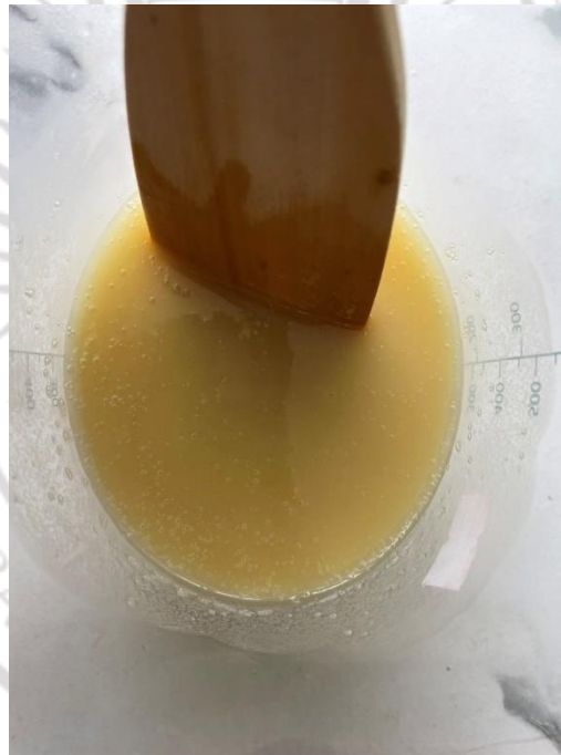
ภาพที่ 3.7 การกวนสารผสมจนได้สารคล้ายสบู่เหลวออกมา เรียก เกล็ดสบู่
