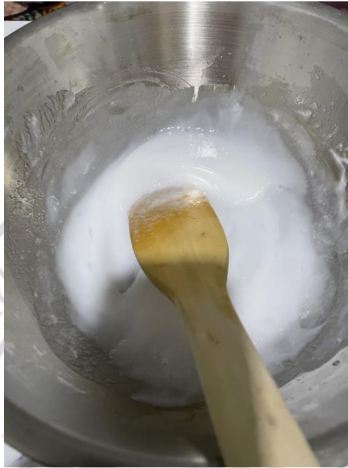
ภาพที่ 3.11 กวนสารโดยผสมน้ำสะอาด ใส่กรดมะนาว และ Plantacare 1200up กวนจนเป็นเนื้อเดียวกัน
