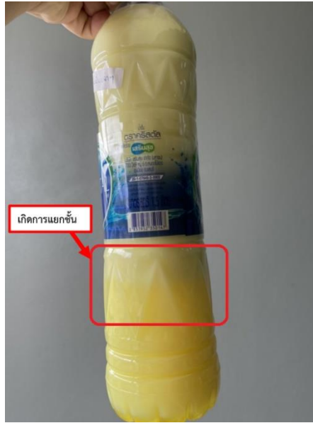
ภาพที่ 4.4 นํ้ายาล้างจานถึงจุดอิ่มตัวเกิดการแยกชั้น และคืนสถานะเป็นนํ้า
