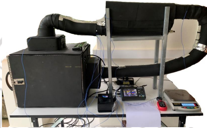
ภาพที่ 3.8 ตู้อบความร้อนที่ติดตั้งชุดแลกเปลี่ยนความร้อนที่ประกอบด้วยท่อความร้อนแบบส้นวงรอบที่ติดตั้งวาล์วกันกลับ (CLOHP/CV)
