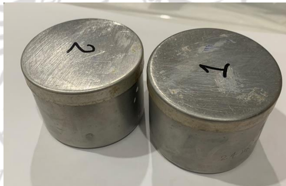
ภาพที่ 3.7 ภาชนะใส่ตัวอย่างเพื่อทดสอบความชื้นเริ่มต้น
