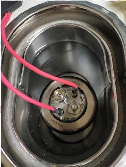
ภาพที่ 3.9 ภาชนะทดสอบที่บรรจุน้ำขนาด 2 ลิตรในเครื่องบอมบ์แคลอรีมิเตอร์
