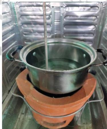
ภาพที่ 3.10 การทดสอบประสิทธิภาพการใช้งานของเชื้อเพลิง โดยการทดลองต้มน้ำเดือด
