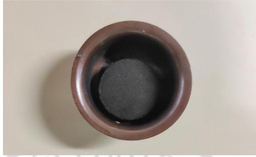
ภาพที่ 3.6 ชิ้นงานทดสอบค่าปริมาณความร้อนของเชื้อเพลิงอัดแท่งตามมาตรฐาน ASTM D5865
