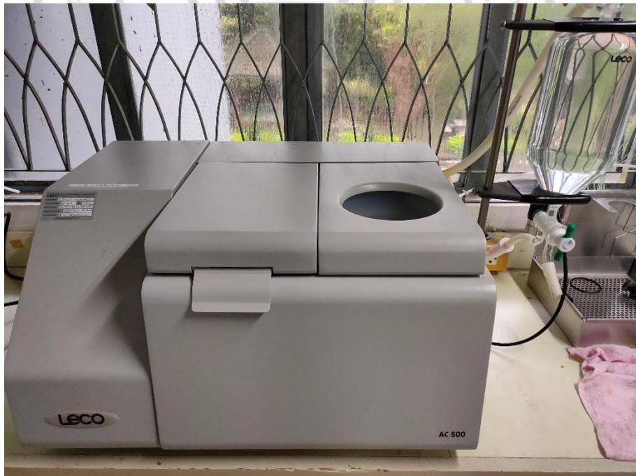
ภาพที่ 3.5 เครื่องวิเคราะห์ค่าความร้อน Bomb calorimeter
