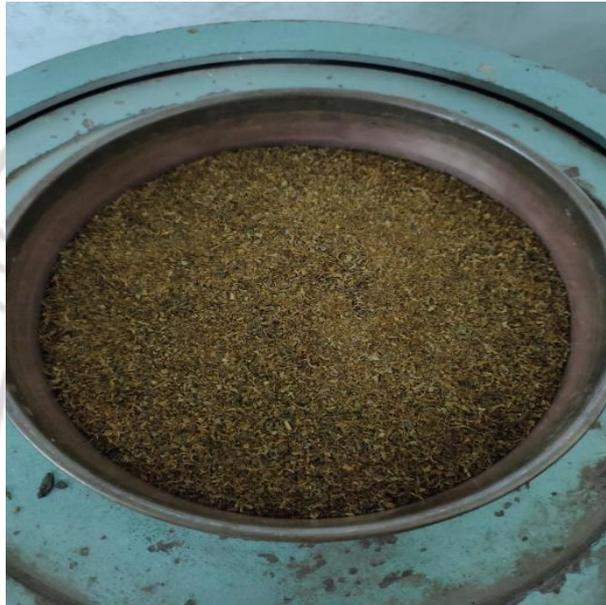
ภาพที่ 4.2 กากสมุนไพรที่ผ่านการคัดแยกขนาดอนุภาคด้วยตะแกรง Mesh No.12
