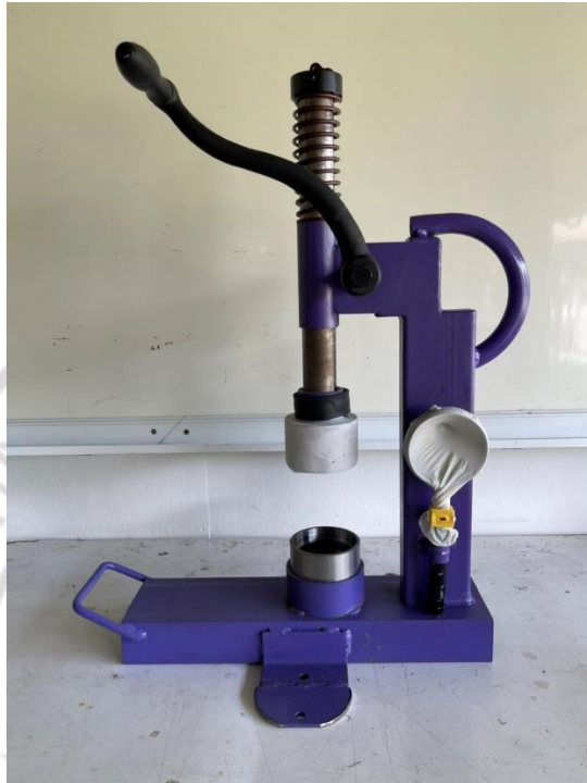
เครื่องอัดขึ้นรูปอีเอ็มบอลต้นแบบ
