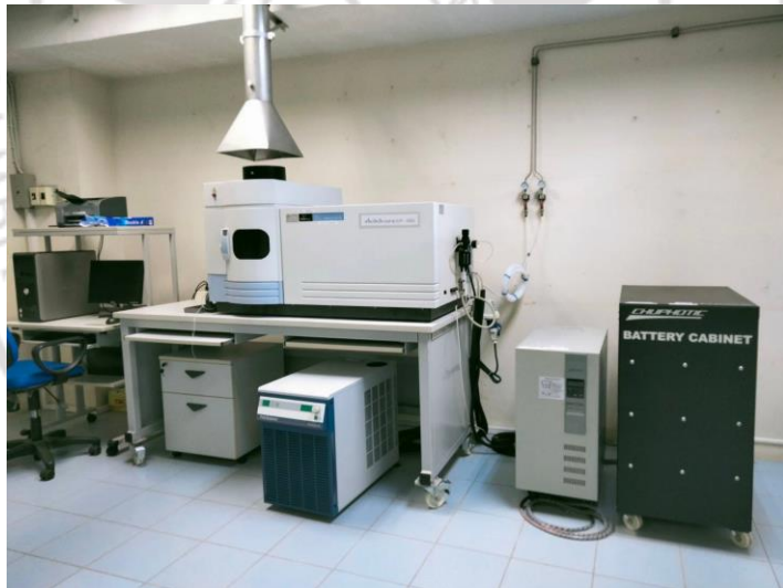
ภาพภาคผนวก ง ที่ 2 เครื่องวัดปริมาณธาตุ (ICP-OES)
