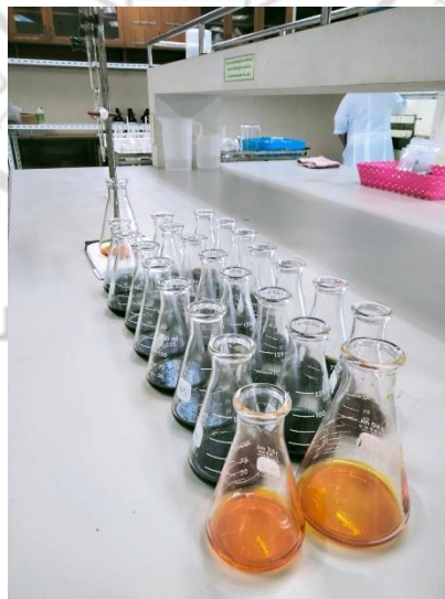
ภาพภาคผนวก ง ที่ 3 ภาพการวิเคราะห์อินทรีย์คาร์บอนหรืออินทรีย์วัตถุ (OC หรือ OM)
