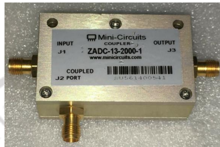
ภาพที่ 3.4 อุปกรณ์เชื่อมต่อสัญญาณแบบมีทิศทาง ZADC-13-2000-1
