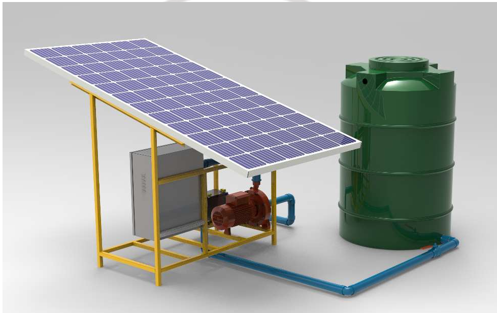
ภาพที่ 3.1 แบบจำลองต้นแบบระบบปั้มน้ำพลังงานแสงอาทิตย์แบบอัตโนมัติ
