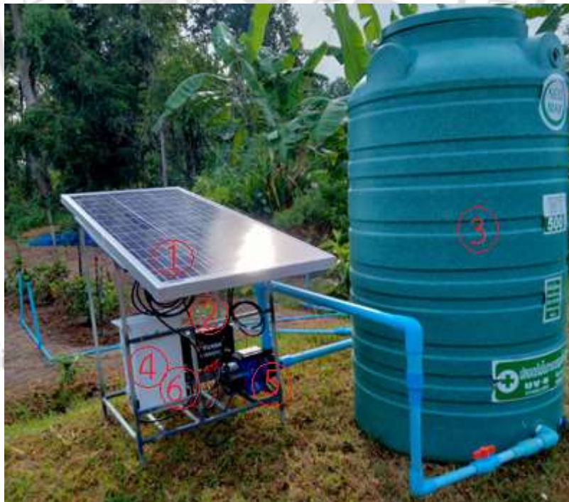
ภาพที่ 4.1 อุปกรณ์ชุดต้นแบบเครื่องสูบน้ำพลังงานแสงอาทิตย์
