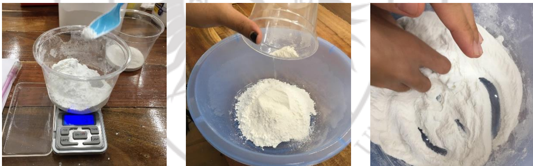
ภาพที่ 3.12 การเตรียมส่วนผสมเปลือกหอยแมลงภู่มและผสมคนให้เข้ากัน
