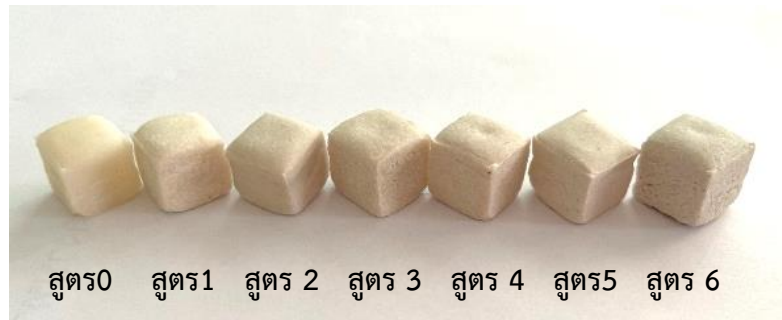
ภาพที่ 4.3 ดินจากแป้งข้าวเหนียวสูตร 0 และดินจากเปลือกหอยแมลงภูสูตร 1 ถึงสูตร 6
