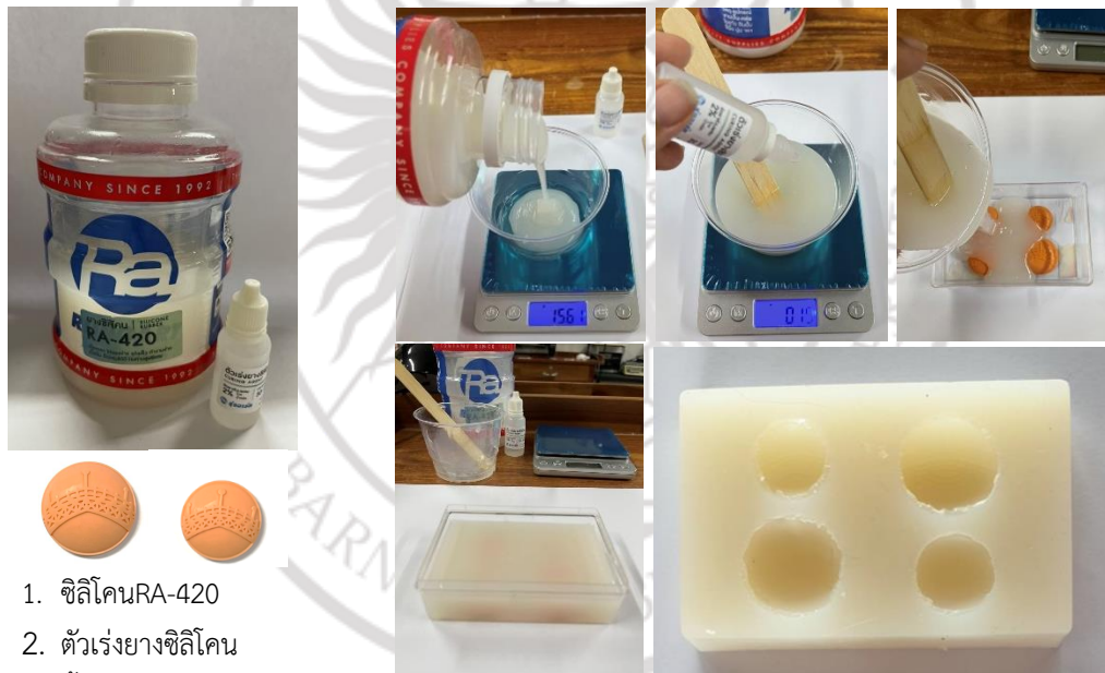
ภาพที่ 4.16 ขั้นตอนการทำแม่พิมพ์ซิลิโคน
