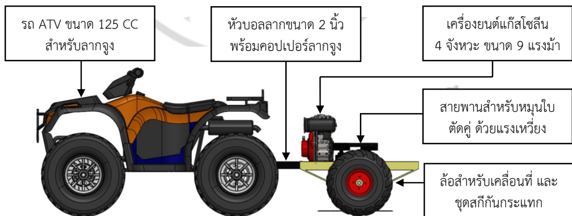
ภาพที่ 3.7 เครื่องตัดหญ้าหางลากใบพัดแรงเหวี่ยงคู่ สำหรับเกษตรกรฐานรากในระดับครัวเรือน
