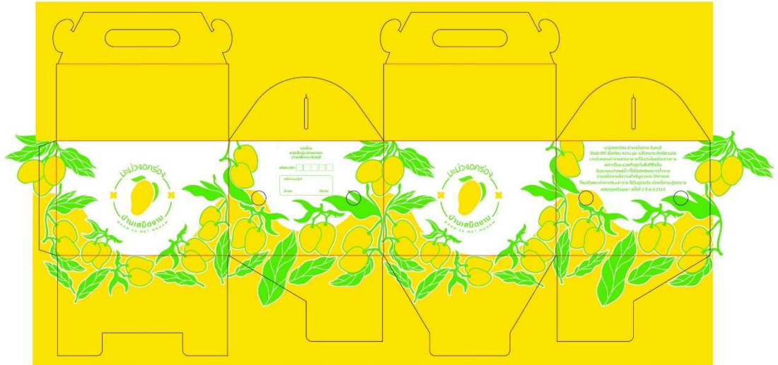
ภาพที่ 4.23 ร่างต้นแบบบรรจุภัณฑ์กว้าง x ยาว x สูง แบบพิมพ์สองสี
