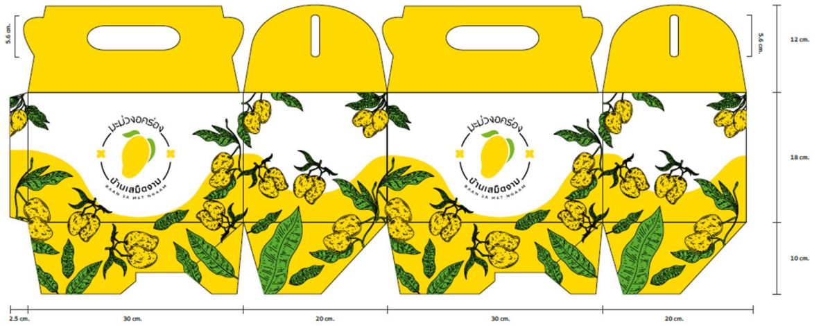
ภาพที่ 4.20 ร่างแบบบรรจุภัณฑ์กว้าง x ยาว x สูง ประเภทกล่องลูกฟูก แบบที่ 1 ครั้งที่ 2
