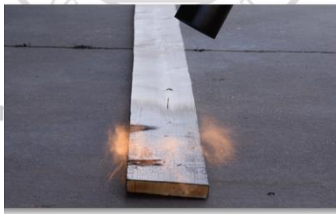
ภาพที่ 2.15 แสดงขั้นตอนการเผาไม้ด้วยหัวพันไฟ ที่มา : (Instructable Workshop, 2018)
