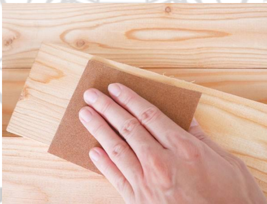
ภาพที่ 2.21 การใช้กระดาษทรายขัดผิวไม้ให้เรียบ ที่มา : (Lora S. Irish, 2018 : 2)
