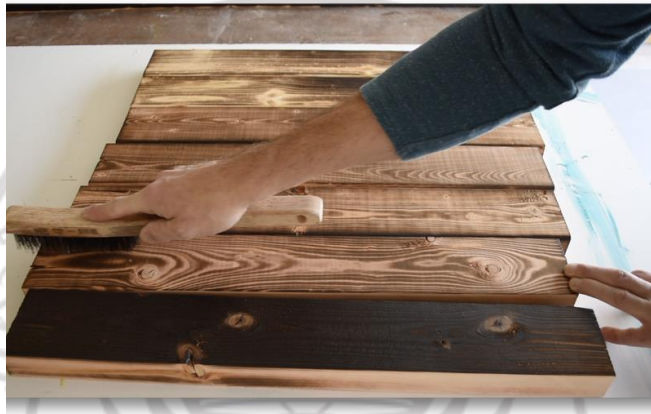
ภาพที่ 2.16 แสดงขั้นตอนการใช้แปรงลวดขัดเขม่าส่วนเกินออก ที่มา : (Instructable Workshop, 2018)
