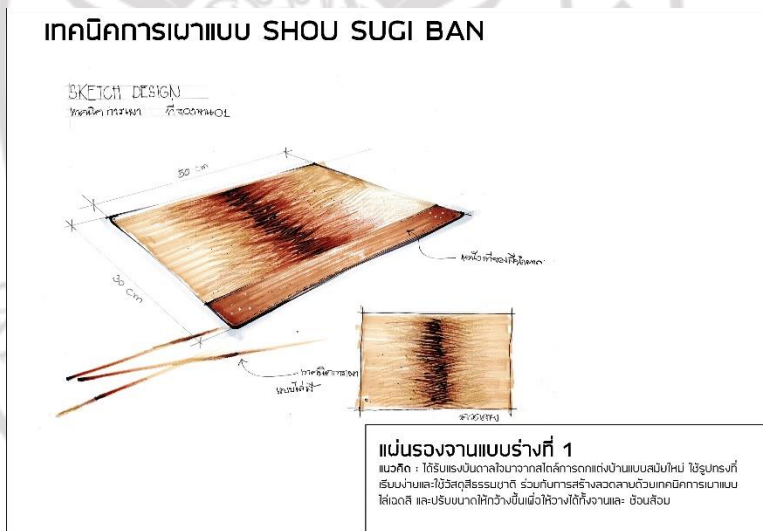
ภาพที่ 4.17 แบบร่างแผ่นรองจานและชั้นส้อมที่ใช้เทคนิคการเผาแบบ เซาสูกิบัน แบบที่ 1
