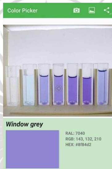
ภาพที่ 3.1 แสดงตัวอย่างวิธีการวัดค่าความเข้มข้น
