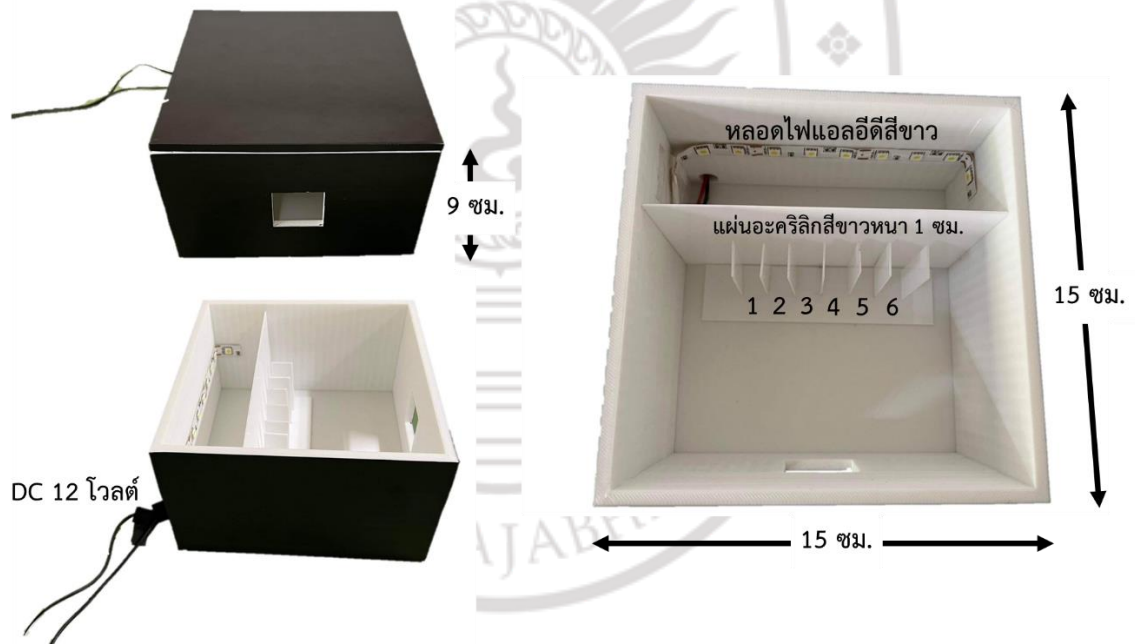
ลิขสิทธิ์ของมหาวิทยาลัยราชภัฏรำไพพรรณี ภาพที่ 4.1 กล่องอุปกรณ์วัดค่าสีอย่างง่ายที่สร้างจากเครื่องพิมพ์ 3 มิติ
