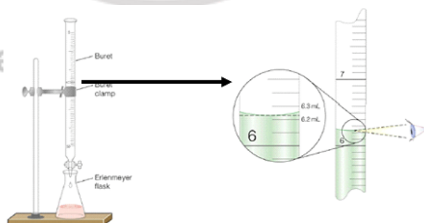
ภาพที่ ข.3 การไทเทรตกรด เบส (Acid-base titration)
