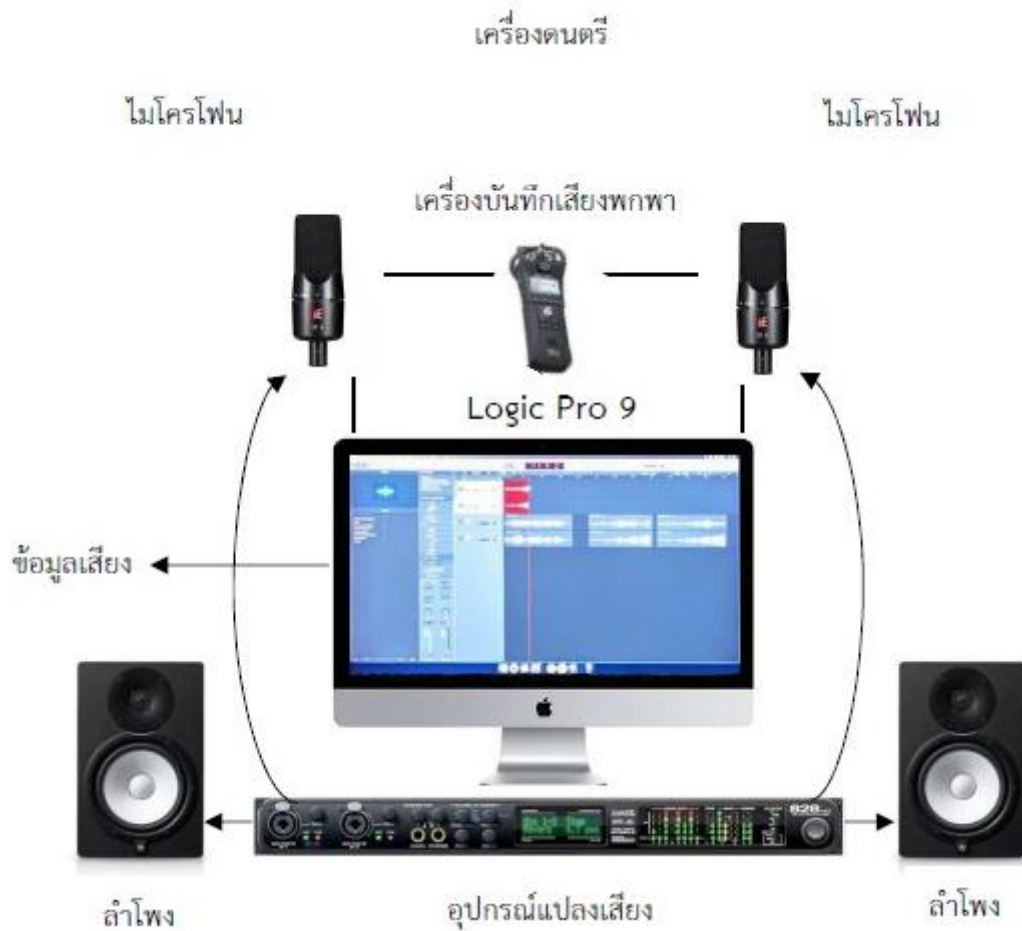
ภาพที่ 4.2 แผนผังการเชื่อมต่ออุปกรณ์ในการบันทึกเสียงเครื่องดนตรี
