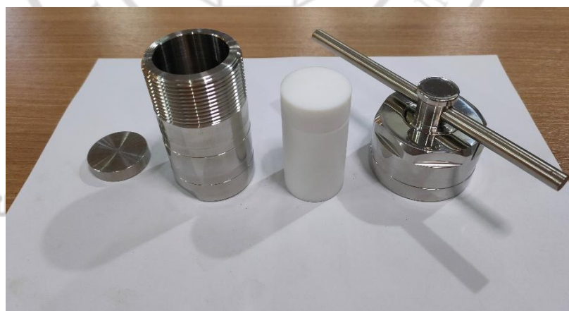
ภาพที่ 3.5 อุปกรณ์สำหรับเตรียมถ่านกัมมันต์ด้วยเทคนิคไฮโดรเทอร์มอล
