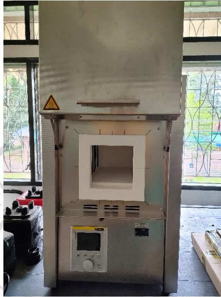
ภาพที่ 3.6 เตาความร้อนสำหรับการเตรียมถ่านกัมมันต์ด้วยเทคนิคไฮโดรเทอร์มอล
