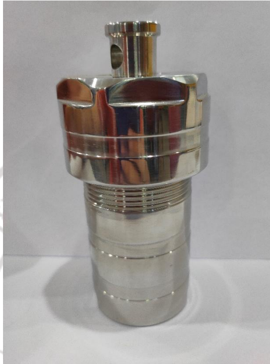
ภาพที่ 3.10 ชุดไฮโดรเทอร์มอลที่บรรจุถ่านเปลือกมังคุดและสารละลายเบสโพแทสเซียมไฮดรอกไซด์
