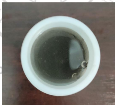
ภาพที่ 3.9 กระบอกบรรจุของชุดปฏิกรณ์ไฮโดรเทอร์มอลที่มีสารละลายเบสโพแทสเซียมไฮดรอกไซด์ และถ่านเปลือกมังคุด
