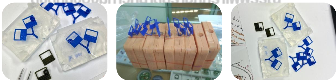
ภาพที่ 4.12 ภาพการอัดก้อนยางแม่พิมพ์
