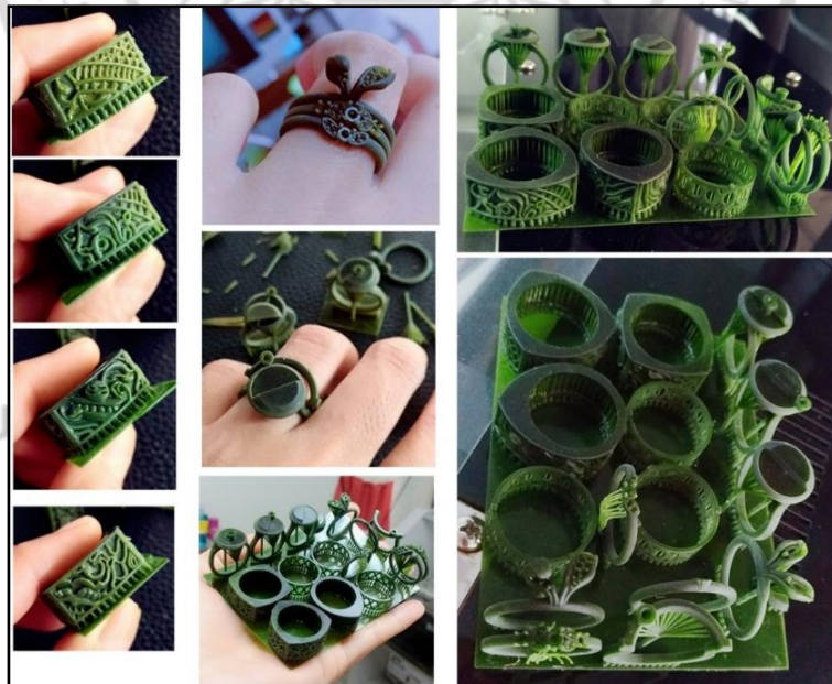
ภาพที่ 2.15 ตัวอย่างแม่พิมพ์เครื่องประดับเรซิน จากการพิมพ์ เครื่องแรพพิด โพรโทไทป์
