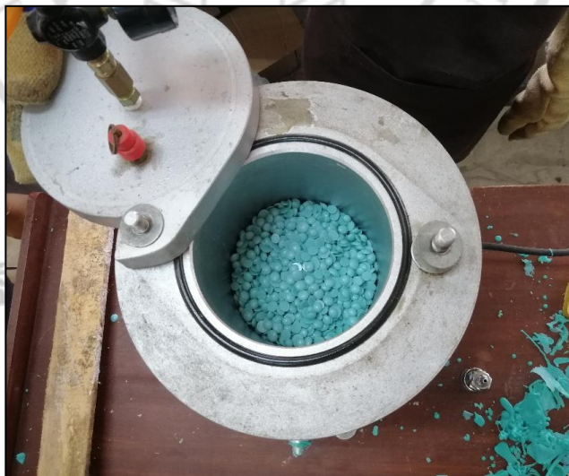
ภาพที่ 2.26 เตรียมขี้ผึ้งโดยหลอมละลายในหม้อฉีดเทียน
