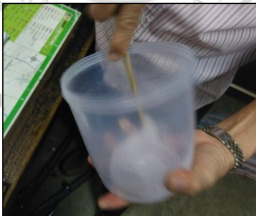
ภาพที่ 2.21 การคนส่วนผสมซิลิโคนสารเร่งความแข็งซิลิโคนให้เป็นเนื้อเดียวกัน
