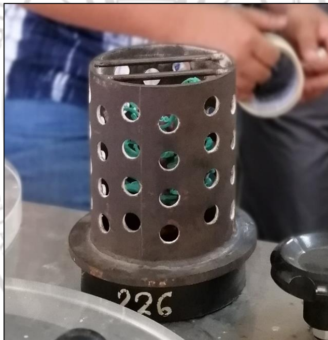
ภาพที่ 2.31 เบ้าสำหรับเทปูนสำหรับงานหล่อ
