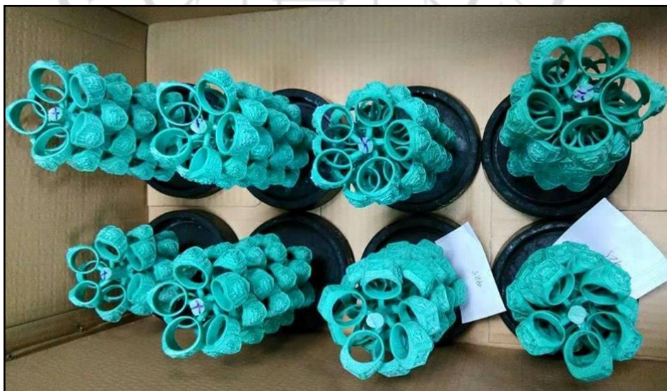
ภาพที่ 2.30 การติดต้นเทียน ก่อนนำไปหล่อโลหะ ที่มา : (Deluxury, 2559)
