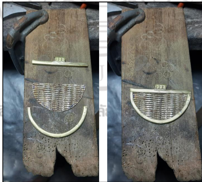
ภาพที่ 4.18 การประกอบแผ่นทองเหลืองกับตัวเรือนเครื่องประดับ
