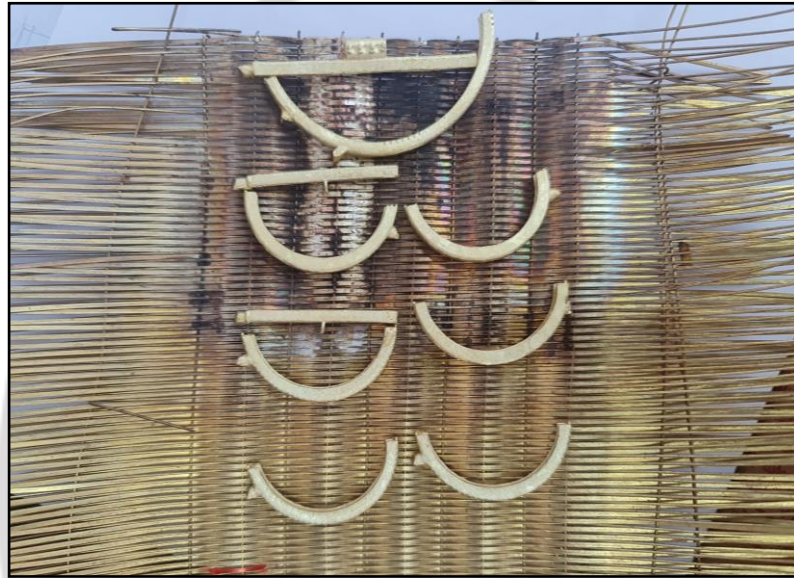
ภาพที่ 4.17 การนำแผ่นทองเหลืองวัดขนาดและรูปแบบชิ้นส่วนตัวเรือนเครื่องประดับ
