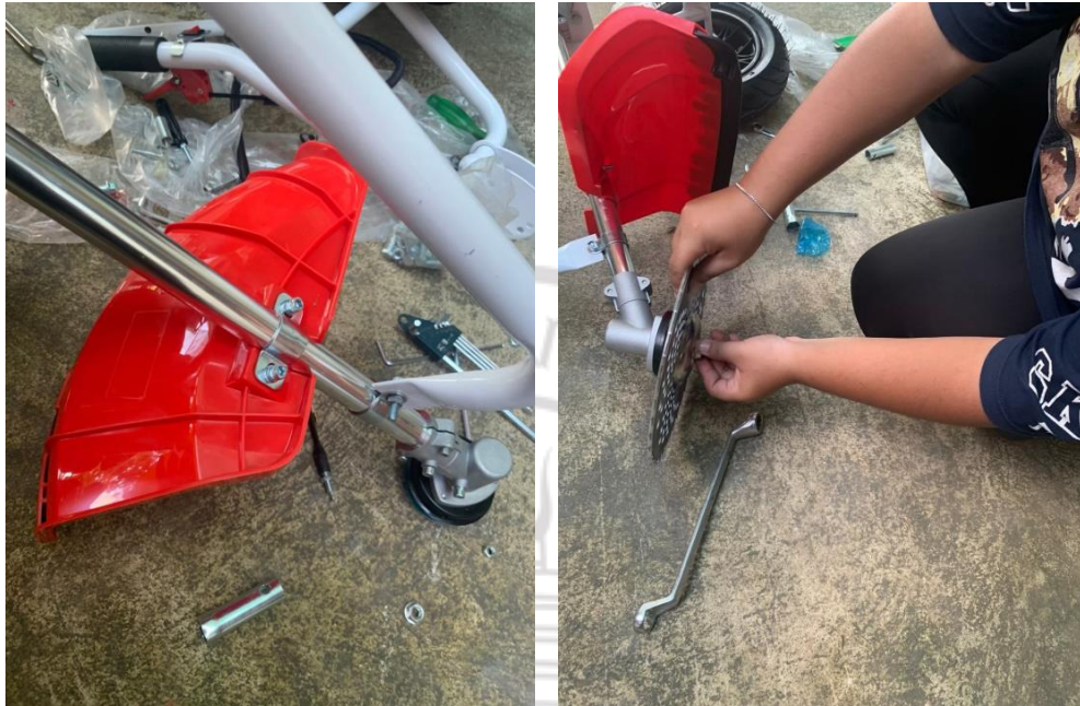
ภาพที่ 4.2 แสดงการติดตั้งแผ่นกันกระเด็นและการติดตั้งชุดใบมีดเครื่องตัดหญ้า
