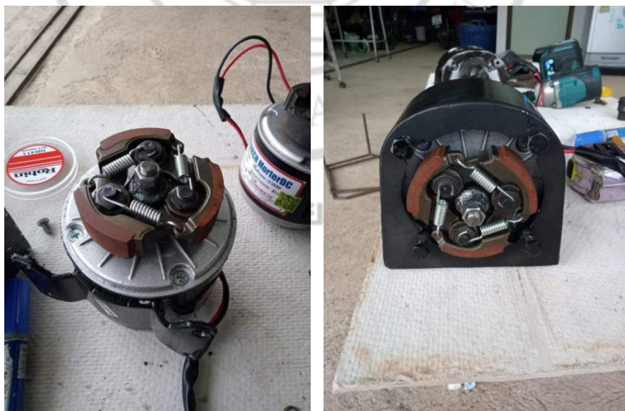
ภาพที่ 4.5 แสดงการติดตั้งชุดคลัชข้อเหวี่ยงเข้ากับแกนเพลลาของมอเตอร์ไฟฟ้ากระแสตรง
