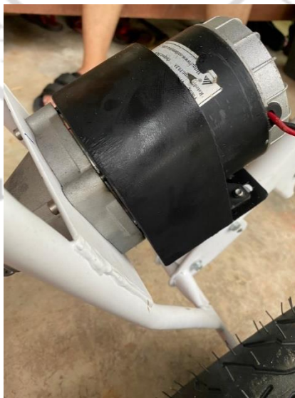
ภาพที่ 4.7 แสดงการติดตั้งมอเตอร์เข้ากับชุดแผ่นเพลทและชุดคลัชข้อเหวี่ยง
