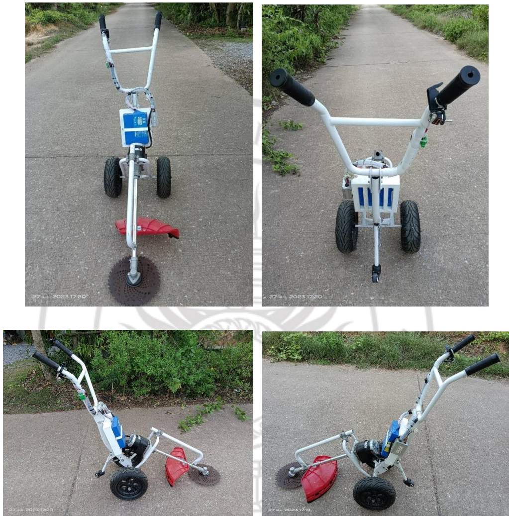
ภาพที่ 4.14 แสดงลักษณะเครื่องตัดหญ้าพลังงานไฟฟ้าชนิดเข็นเดินตามที่เสร็จสมบูรณ์
