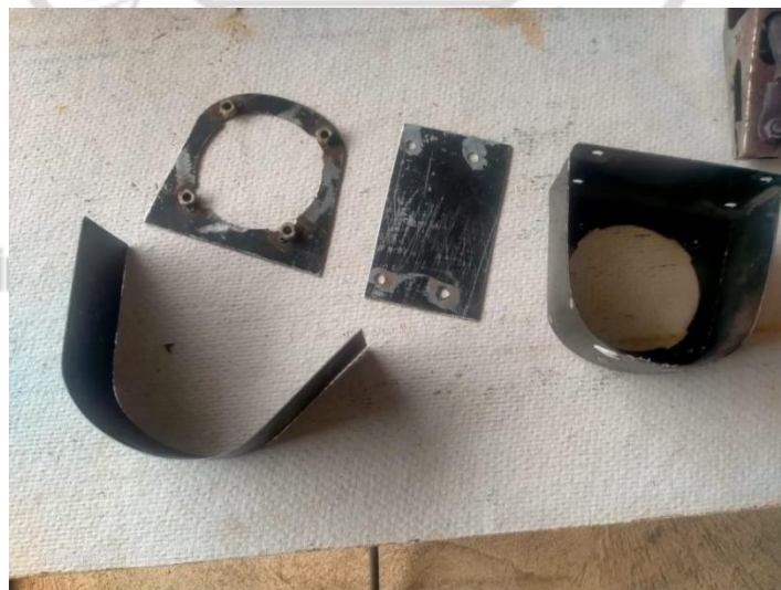
ภาพที่ 4.3 แสดงชิ้นส่วนต่างๆของชุดอุปกรณ์จับยึดมอเตอร์
