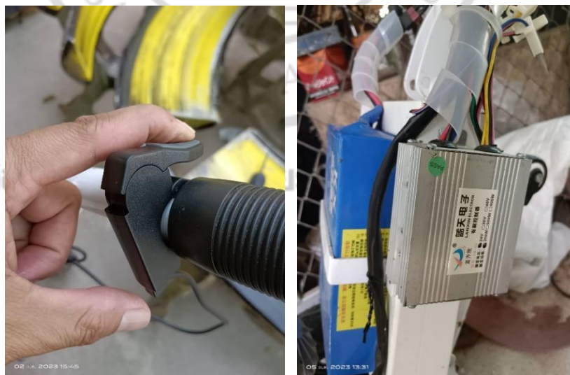
ภาพที่ 4.11 แสดงลักษณะการติดตั้งสวิตช์ควบคุมความเร็ว และการติดตั้งกล่องคอนโทรล
