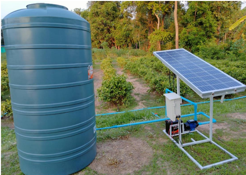
ภาพที่ 4.1 ชุดต้นแบบระบบน้ำหยดพลังงานแสงอาทิตย์ควบคุมอัตโนมัติ ๓
