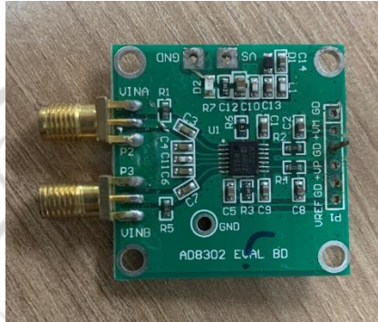
ภาพที่ 2.2 โครงสร้างภายนอกของอุปกรณ์ AD8302
