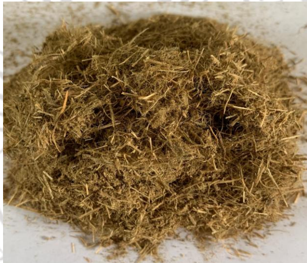
ภาพที่ 3.3 ลักษณะการบดละเอียดของกิ่งสละที่ผ่านการอบแห้ง
