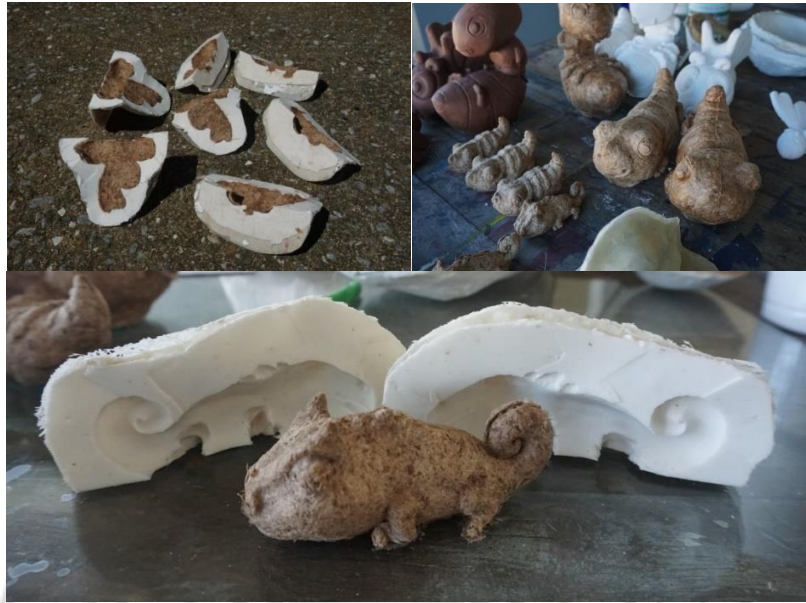
ภาพที่ 4.4 ขึ้นรูปทรงด้วยกระดาษหอยกกล้วยโดยแม่พิมพ์ซิลิโคน
