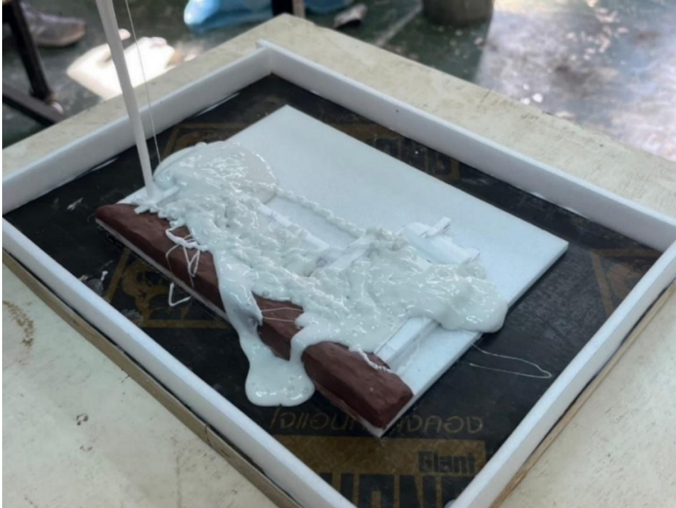
ภาพที่ 4.21 ทำแม่พิมพ์ซิลิโคน
