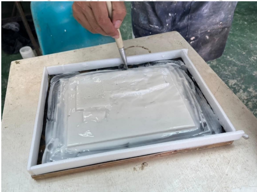
ภาพที่ 4.21 ทำแม่พิมพ์ซิลิโคน
