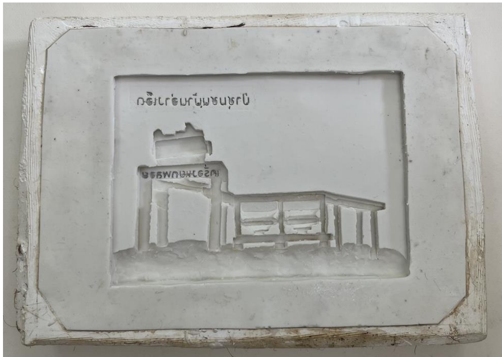
ภาพที่ 4.23 ทำพิมพ์ครอบด้วยปูนปลาสเตอร์ จากนั้นแม่พิมพ์จึงพร้อมใช้งาน
