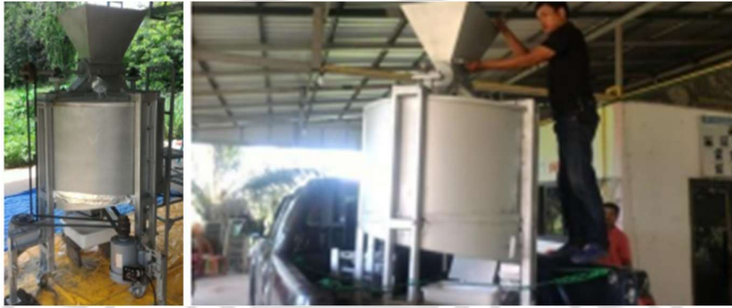
ภาพที่ 2.8 ต้นแบบเครื่องจักรบดย่อยพืชผักและสมุนไพร ที่มา : (ศักดิ์ชัย อาษาวิง, 2561 : 38)
