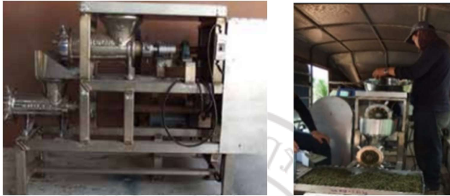
ภาพที่ 2.10 เครื่องบดใบชาสำหรับการแปรรูปชาฝรั่ง ที่มา : (เกรียงศักดิ์ และคนอื่น ๆ . 2564 : 221 - 223)
