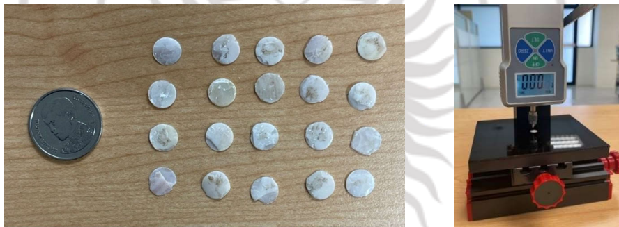
ภาพที่ 4.11 การเตรียมวัสดุและ Digital Force Gauge สำหรับทดสอบหาแรงกด
