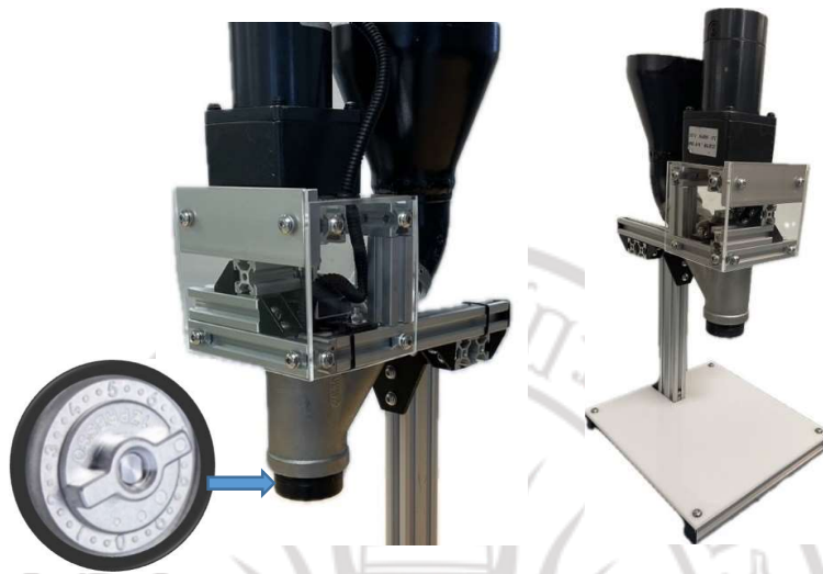
ภาพที่ 4.26 เครื่องบดเปลือกหอยแมลงภู่จากหลักการบดแบบไจราทอรี
