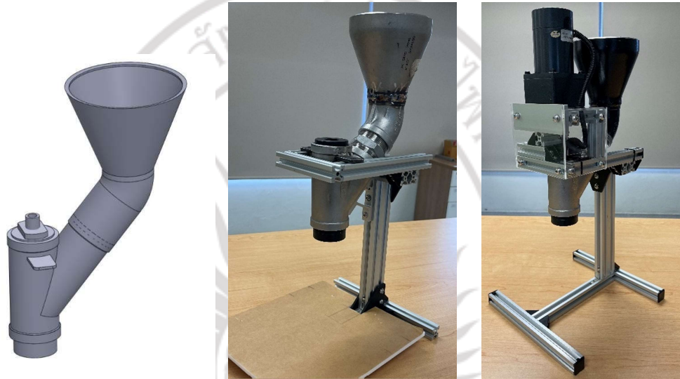
ภาพที่ 4.25 ทำโครงยึดข้อต่อสามทางกับกรวยและมอเตอร์
