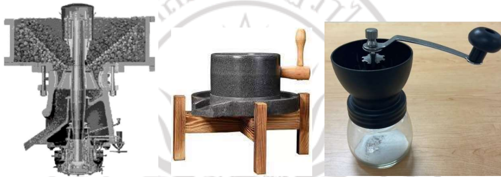
ภาพที่ 4.5 การบดแบบไจราทอรี ที่ประยุกต์เป็นเครื่องโม่หินและเครื่องบดกาแฟแบบมือหมุน ที่มา : (Magdi Abadir , n.d. : 45)
